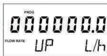
En un CH420R, si durante la programación se recibe un comando HART que debe ser atendido, la programación local no será válida y se perderán todos los datos previamente programados. La pantalla volverá al modo de funcionamiento normal y quedará la palabra PROG iluminada, indicando que ha ocurrido este evento. Para apagar la palabra PROG del display, basta con pulsar cualquiera de las dos teclas PROG.
