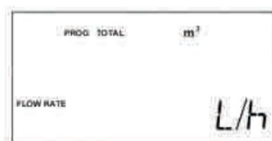
Para cambiar las unidades de caudal, debe pulsar la tecla marcada con la flecha hacia arriba. Para cambiar las unidades de volumen totalizado, debe pulsar la tecla marcada con la flecha hacia la izquierda.
